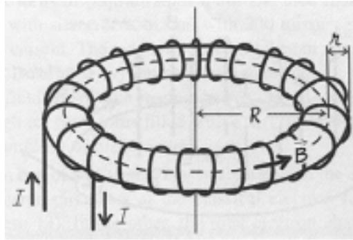
1. Une bobine est constituée de N spires de conducteur bobinées régulièrement sur un noyau torique de perméabilité magnétique  $\mu$  avec  $\mu \gg \mu_0$ . Soit R le rayon moyen du tore et r le rayon de sa section circulaire avec  $R \gg r$ . La bobine est parcourue par un courant I.
