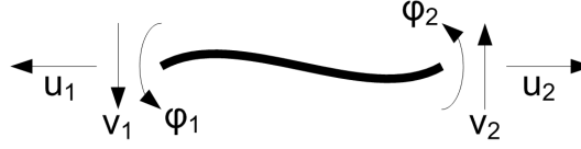
FIGURE 3.1 – Système d'axes local pour un élément de poutre
