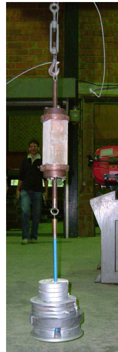
FIGURE 5.10 – Essai de traction pure sur l'assemblage mortier - briques
