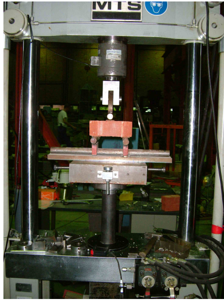
FIGURE 5.2 – Essai de flexion 3 points sur une brique
