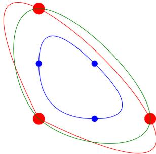
Nous allons estimer la représentation paramétrique  $C^0$  de cette trajectoire avec une interpolation polynomiale, une approximation B-spline uniforme  $C^1$  de degré deux et une interpolation  $C^2$  avec des splines cubiques usuelles.
