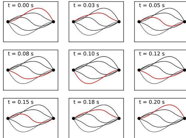
Figure 12.1: Solution analytique avec un incrément temporel de  $T/8$  où  $T$  est la période : la position initiale est  $u_0 \left(1 - \frac{x}{L}\right) \left(\frac{x}{L}\right)^2$  avec une vitesse initiale nulle..
