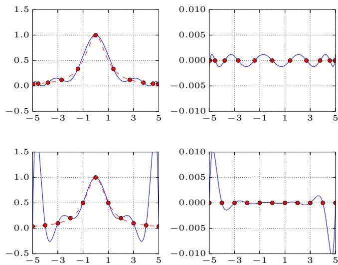
Figure 1.3: Comparaison entre des interpolations polynomiales de degré 10 faites avec des abscisses équidistantes ou avec des abscisses de Chebyshev. On a également représenté le diagramme du terme  $(x - X_0)(x - X_1) \dots (x - X_n) / (n + 1)!$ . Le choix des abscisses de Chebychev permet de réduire l'ampleur de ce facteur du terme d'erreur et d'obtenir la convergence de l'approximation polynomiale.
