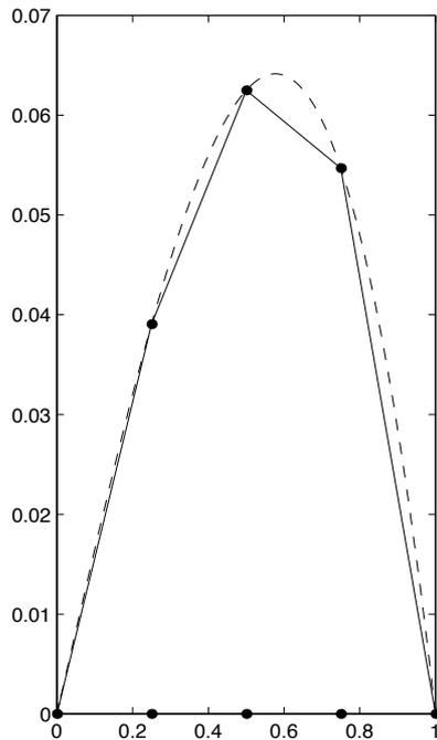
$$\frac{1}{h} \begin{bmatrix} 1 & -1 & & & \\ -1 & 2 & -1 & & \\ & -1 & 2 & -1 & \\ & & -1 & 2 & -1 \\ & & & -1 & 1 \end{bmatrix} \begin{bmatrix} U_1 \\ U_2 \\ U_3 \\ U_4 \\ U_5 \end{bmatrix} = \frac{h}{6} \begin{bmatrix} 1/4 \\ 6/4 \\ 12/4 \\ 18/4 \\ 11/4 \end{bmatrix}$$
