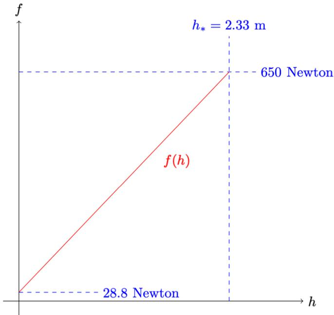
Evolution de la force de frottement en fonction de la hauteur de l'ouvrier
