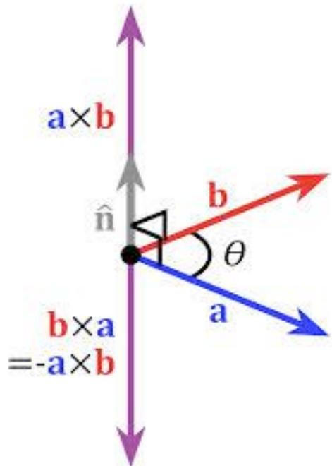
$$\vec{C} = \vec{A} \times \vec{B} = \begin{bmatrix} A_y B_z - A_z B_y \\ A_z B_x - A_x B_z \\ A_x B_y - A_y B_x \end{bmatrix}$$
