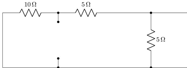
Nous déterminons la résistance équivalente du circuit vue entre les deux bornes où se trouvait la lampe. On obtient une **résistance équivalente de Thévenin de 5 Ω** en constatant que les deux résistances de 5 Ω sont en série (on peut les remplacer par une résistance équivalente de 10 Ω), en parallèle avec la résistance de 10 Ω.
