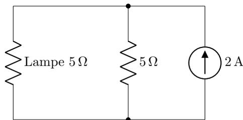
Le courant dans la lampe est déterminé à partir de la relation pour les diviseurs de courant (ici, il se divise simplement en deux entre la lampe et la résistance équivalente de 5 Ω provenant de la combinaison des deux résistances de Norton en parallèle), ce qui donne 1 A. La puissance de la lampe est  $P = 5 \text{ W}$ .
