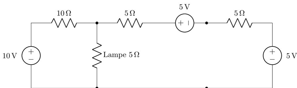
Ce qui après combinaison des sources dans la branche à droite revient au circuit suivant faisant apparaître les deux sources connectées en parallèle entre elles et avec la lampe :
