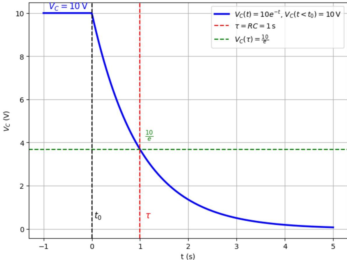
Le **courant traversant la résistance** suit la loi d'Ohm, valable en tout temps :  $V_R = RI_R$ . Etant donné que la résistance est directement connectée aux bornes du condensateur, les tensions sont identiques :  $V_R(t) = V_C(t)$ , ce qui fournit finalement :
