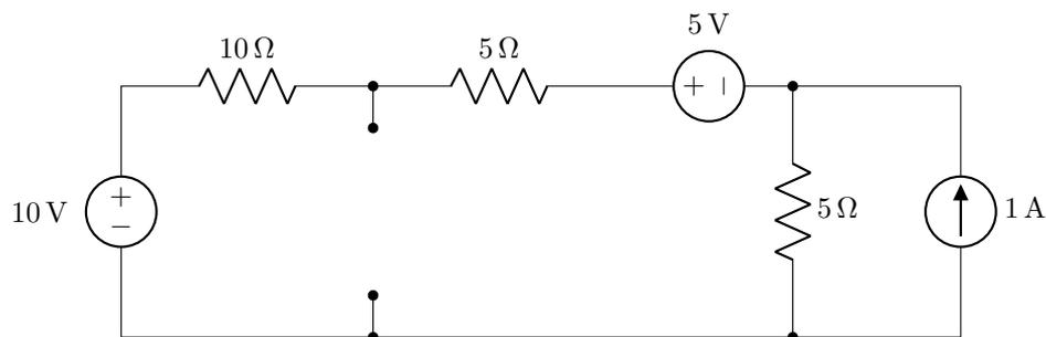
Dans ce schéma, nous déterminons d'abord la tension présente aux bornes après avoir retiré la lampe. Nous aurons deux courants inconnus qui sont  $I_1$  dans la branche constituée des deux sources de tension, et  $I_2$  dans la branche de la résistance de 5 Ω seule. A partir du nœud en bas du schéma qu'on place arbitrairement à la masse (0 V), le nœud en haut du schéma suit les relations suivantes :
