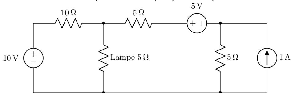
**Solution.** La puissance de la lampe est donnée par la relation de Joule  $P = VI$ , avec  $V$  la différence de potentiel (tension) aux bornes de la lampe et  $I$  le courant traversant la lampe.
