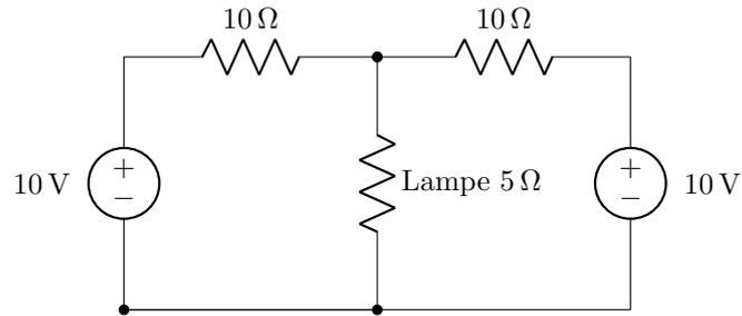
Les deux sources de tension (10 V, 10 Ω) sont avantageusement remplacées par des équivalents de Norton (1 A, 10 Ω) à combiner ensemble pour fournir le schéma final ci-après :
