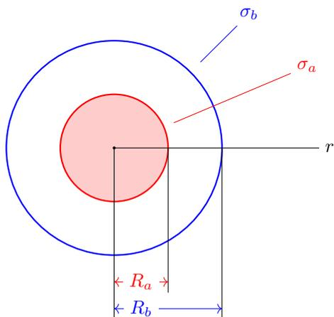
1. Quelle doit être la relation entre la densité surfaciques de charge  $\sigma_a$  sur la surface de l'âme et la densité surfaciques de charge  $\sigma_b$  sur la surface du blindage afin que le champs électrique soit nul à l'extérieur du câble ?
