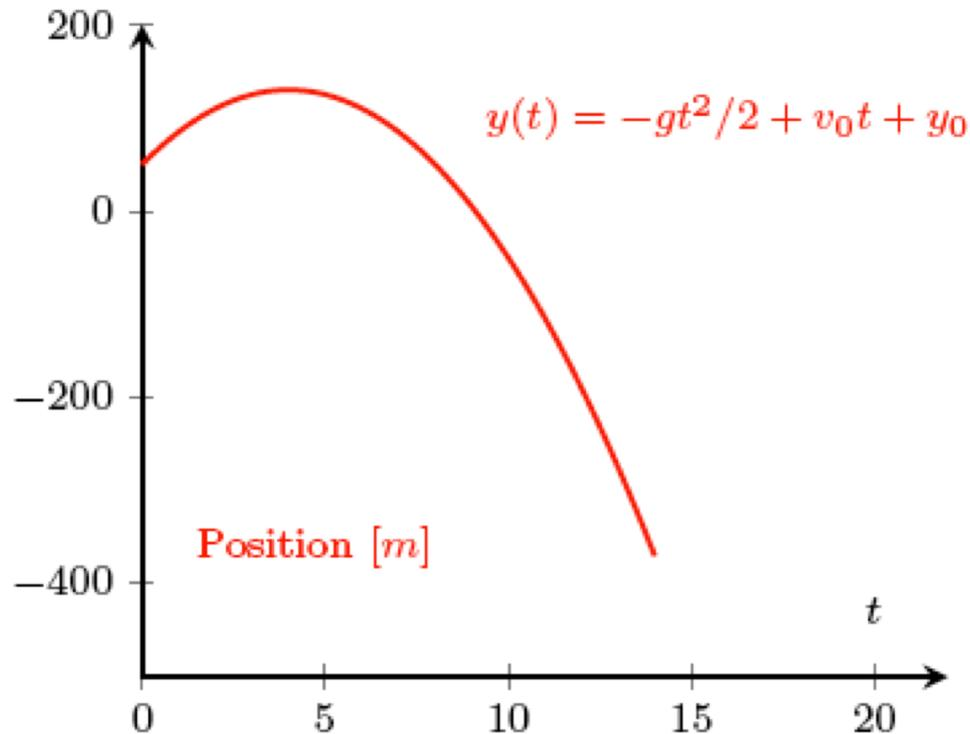
$$\begin{cases} a(t) = -g \\ v(t) = -gt + v_0 \\ y(t) = -gt^2/2 + v_0t + y_0 \end{cases}$$
