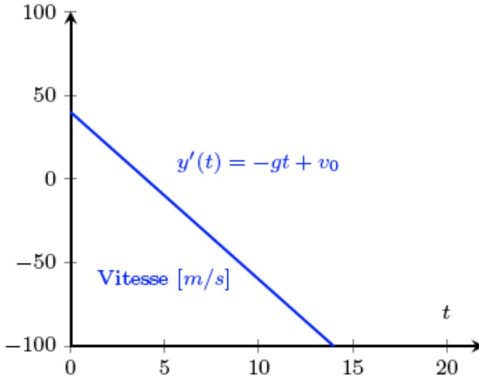
$$\begin{cases} a(t) = -g \\ v(t) = -gt + v_0 \\ y(t) = -gt^2/2 + v_0t + y_0 \end{cases}$$
