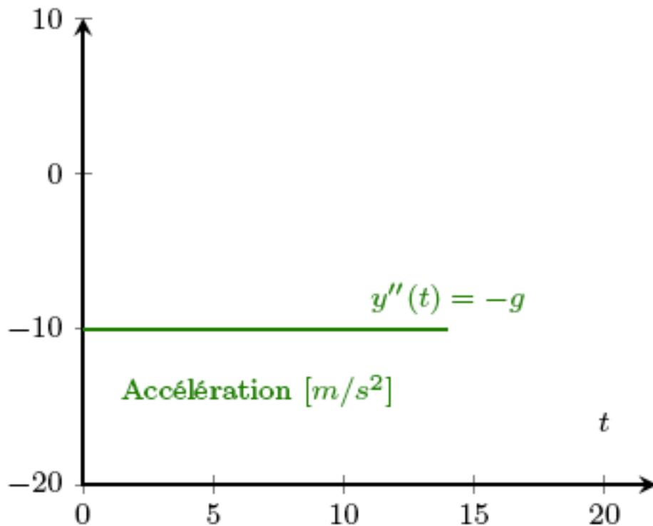
$$\begin{cases} a(t) = -g \\ v(t) = -gt + v_0 \\ y(t) = -gt^2/2 + v_0t + y_0 \end{cases}$$
