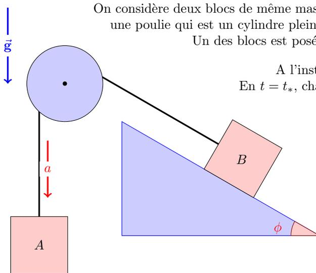
On considère deux blocs de même masse  $m = 2$  kg reliés par une corde qui passe par une poulie qui est un cylindre plein de rayon  $R = 0.25$  m et de masse  $M = 10$  kg. Un des blocs est posé sur un support incliné avec un angle  $\phi = 30^\circ$ .
