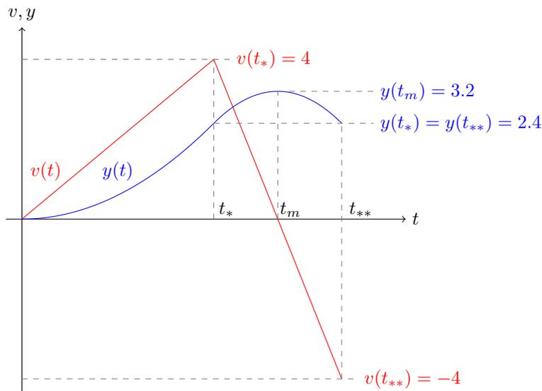
*Il est très aisé d'obtenir que  $t_* = 1.2$ ,  $t_m = 1.6$  et  $t_{**} = 2.0$  secondes, même si cela n'était pas demandé. La courbure des deux parties de la courbe  $y(t)$  doit être correcte pour obtenir la totalité des points de la question. Ce graphe peut être assez facilement deviné avec un tout petit peu d'intuition physique, sans faire aucun calcul :-)*
