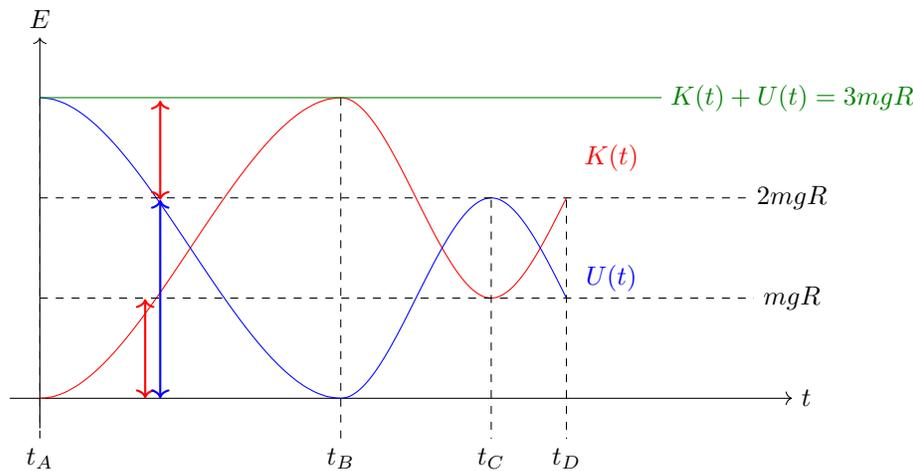
Bien observer que la courbe rouge de l'énergie cinétique peut être vue comme la distance entre la ligne de l'énergie mécanique et la courbe bleue de l'énergie potentielle et inversement. L'écart entre les abscisses temporelles ne peut pas être déterminé : on peut seulement déduire que  $t_D - t_C = (t_C - t_B)/2$  dans le looping, tel qu'indiqué sur le dessin.
