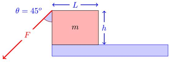
Q1 Quelle est la norme minimale de  $F$  permettant à la caisse de pivoter ?
