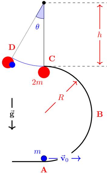
Au point haut  $C$  de cette piste, une seconde bille de masse  $2m$  est suspendue au bout d'une tige rigide de masse négligeable et de longueur  $h = 4$  m. L'extrémité supérieure de cette tige est elle-même fixée avec une articulation à un point fixe. Cette tige crée donc un pendule qui pend immobile à la verticale, lorsque la première bille va entrer en collision avec la seconde !
