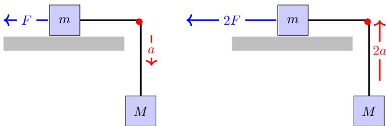
Q4 On peut déduire le rapport des masses des deux blocs à partir de  $a$  et  $F$ . Le déplacement sur la surface horizontale se fait sans aucun frottement. La norme de l'accélération de la gravité est  $g = 10 \text{ m/s}^2$ . Quelle est le rapport des deux masses ?
