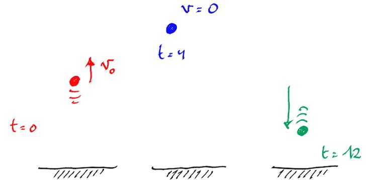
$$\begin{cases} a(t) = -g \\ v(t) = -gt + v_0 \\ y(t) = -gt^2/2 + v_0t + y_0 \end{cases}$$
