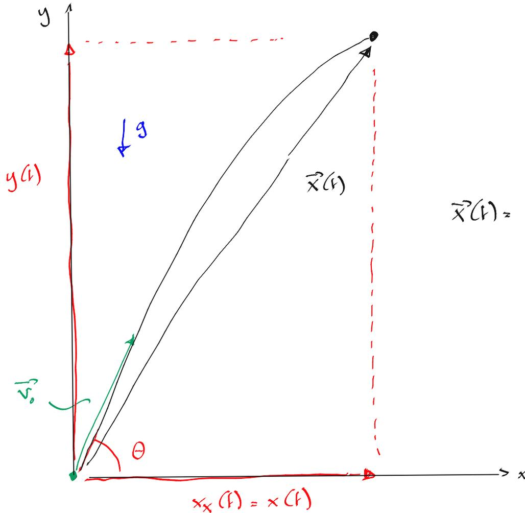
$$\vec{v}_0 = \begin{bmatrix} v_0 \cos \theta \\ v_0 \sin \theta \end{bmatrix} = \begin{bmatrix} v_{x,0} \\ v_{y,0} \end{bmatrix} = \begin{bmatrix} v_0 \\ v_0 \end{bmatrix}$$
