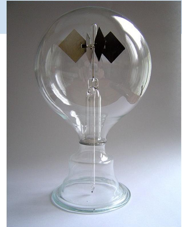
Radiomètre de Crookes
