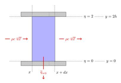
En effectuant le bilan d'énergie sur ce volume de contrôle et en tenant compte que l'énoncé définit explicitement le flux sortant avec un signe négatif, on écrit alors
