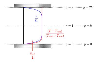
Il faut dessiner des profils turbulents (et donc pas des paraboles!)
