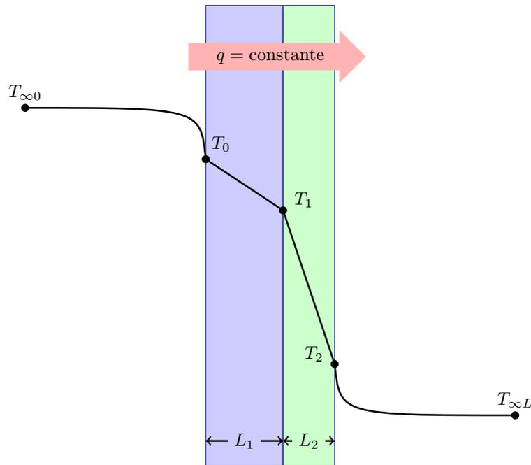
Figure 3: Profil de température dans une plaque avec deux couches distinctes.
