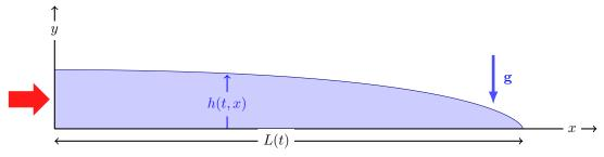
La pression extérieure est  $p_0$ . La viscosité et la masse volumique du fluide sont  $\mu$  et  $\rho$ . L'accélération de la nappe de fluide est supposée négligeable. Le milieu ambiant dans lequel s'écoule la nappe est de l'air dont la masse volumique et la viscosité sont négligeables par rapport à celles de la nappe. Le fluide colle à la paroi inférieure (y=0) et on impose une condition de symétrie sur la surface libre (y=h).
